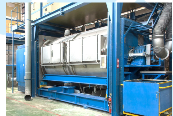
日本最大の羽毛洗濯脱水機
